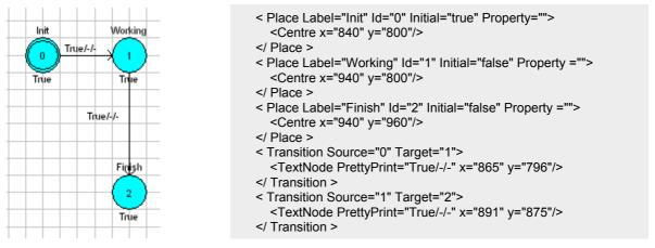
Figure 14: Relation grapheur - représentation XML
