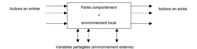
Figure 4 : Représentation d'un composant
